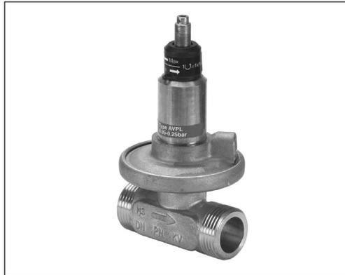
Differenzdruckregler ohne Hilfsenergie für den Einsatz überwiegend in Fernwärmanlagen. Der Regler schließt bei steigendem Differenzdruck.
