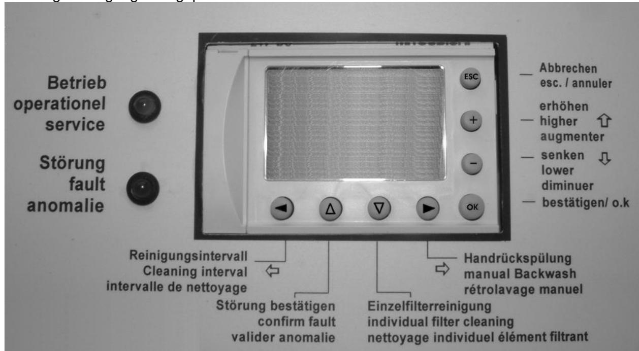
Abb. 5: SPS, Funktionstasten, Beschriftung, LEDs
