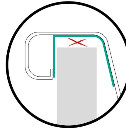
Die raumseitige Abmauerung muß kraftschlüssig und tragfähig **ohne Abstand** zum Schalldämmband ausgeführt sein!
