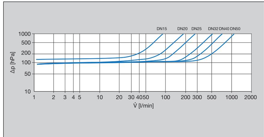
Abb. 1: Leistungsdigramm Druckverlust KRV Press-/Gewindeanschluss
