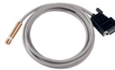
CONTROL-PLUS Einstecktemperaturfühler, Figur 138 00 004 Zur Erfassung der Systemtemperaturen im Trink- wassersystem. Temperaturmessbereich 0 - 100 °C; Kabellänge 2,0 m.
