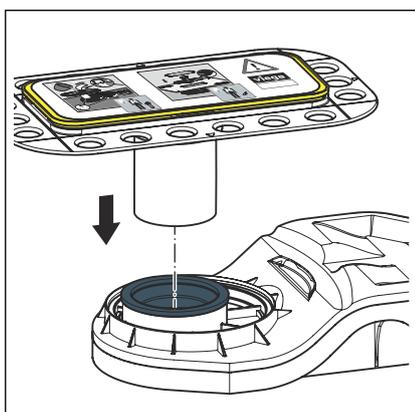
► Den Flansch bis zum Anschlag in den Geruchverschluss einsetzen.
