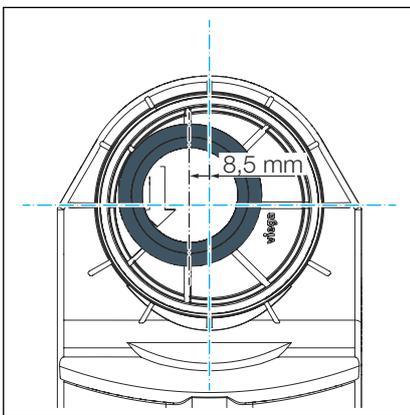
► Den Übergang drehen, um den Ablauf bis zu 8,5 mm exzentrisch zu versetzen.
