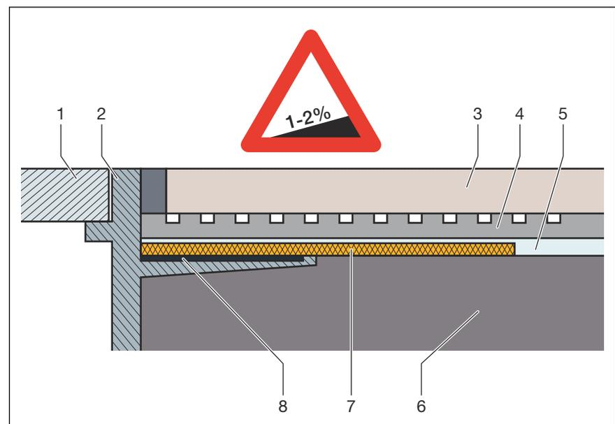
**Abb. 2: Aufbauschema der Verbundabdichtung – Estrichgefälle min. 1–2 %**
