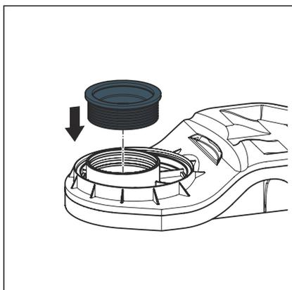
► Die Profildichtung einsetzen.
