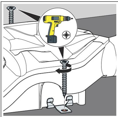
► Die Halteklammern im Boden verschrauben.
