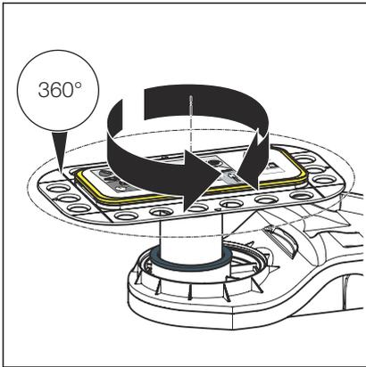
► Der Flansch kann um 360° gedreht werden.
