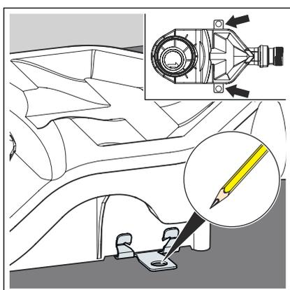
► Die Befestigungspunkte am Boden markieren.
