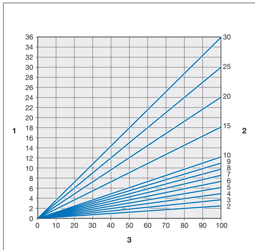
Abb. 3: Längenausdehnung Stahlrohre
