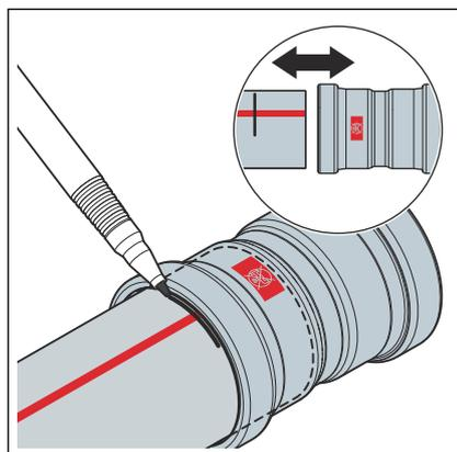
► Die Einstecktiefe markieren und durch vollständiges Abziehen und erneutes Aufstecken des Pressverbinders kontrollieren.
