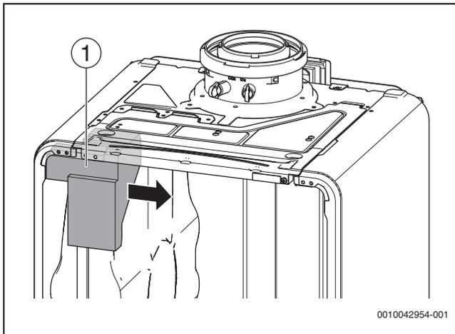
Bild 34 Stützschaum entfernen
