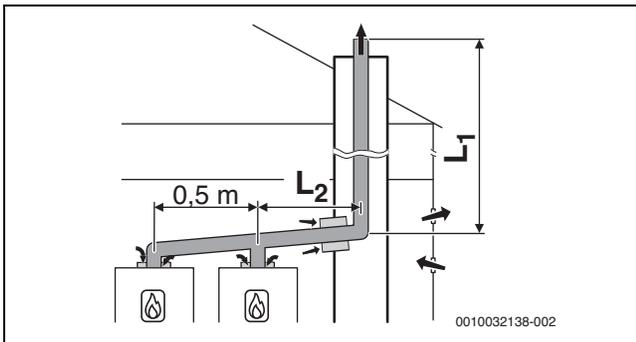
Bild 25 Kaskade mit 2 Geräten:
