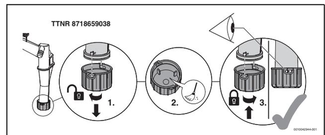
**Bild 84 Schmutzfänger reinigen**
