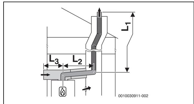
Bild 16 Flexible Abgasführung nach C<sub>53x</sub> im Schacht und Luft-Abgas-Führung mit separater Luftzufuhr und konzentrischer Abgasableitung im Aufstellraum
