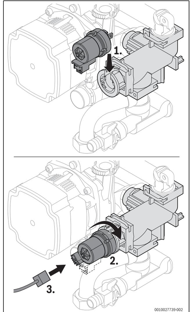
Bild 89 Motor am 3-Wege-Ventil einbauen (Variante ohne Schrauben)
