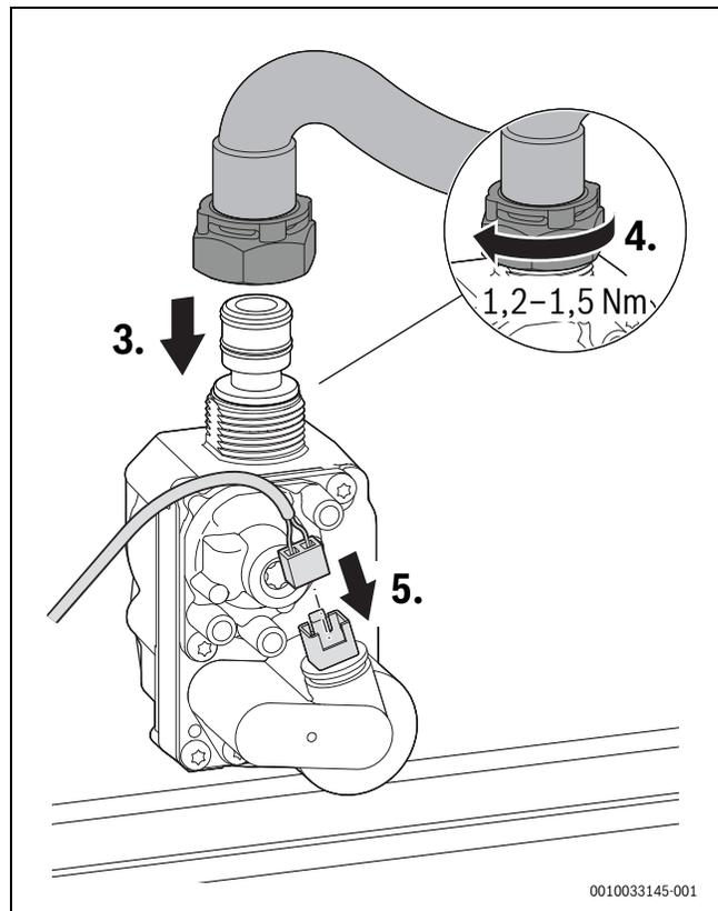
Bild 81 Gasschlauch und Stecker anschließen – Anzugsdrehmoment beachten
