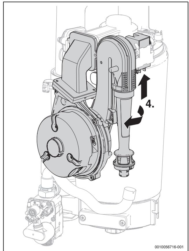
Bild 56 Venturirohr mit Mischeinrichtung und Gebläse abnehmen
