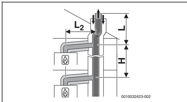
Bild 24 Mehrfachbelegung nach C<sub>(14)3x</sub> mit kollektiver flexibler Abgasableitung und konzentrischer Luft-Abgas-Führung im Aufstellraum
