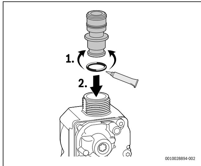
Bild 80 Gassrossel einsetzen
