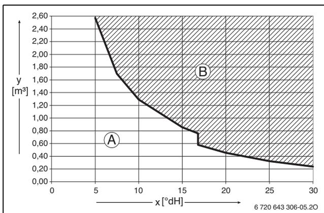
Bild 28 Anforderungen an Füll- und Ergänzungswasser Geräte < 50 kW
