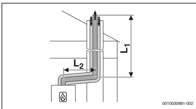
Bild 12 Konzentrische Luft-Abgas-Führung nach C<sub>33x</sub> im Schacht
