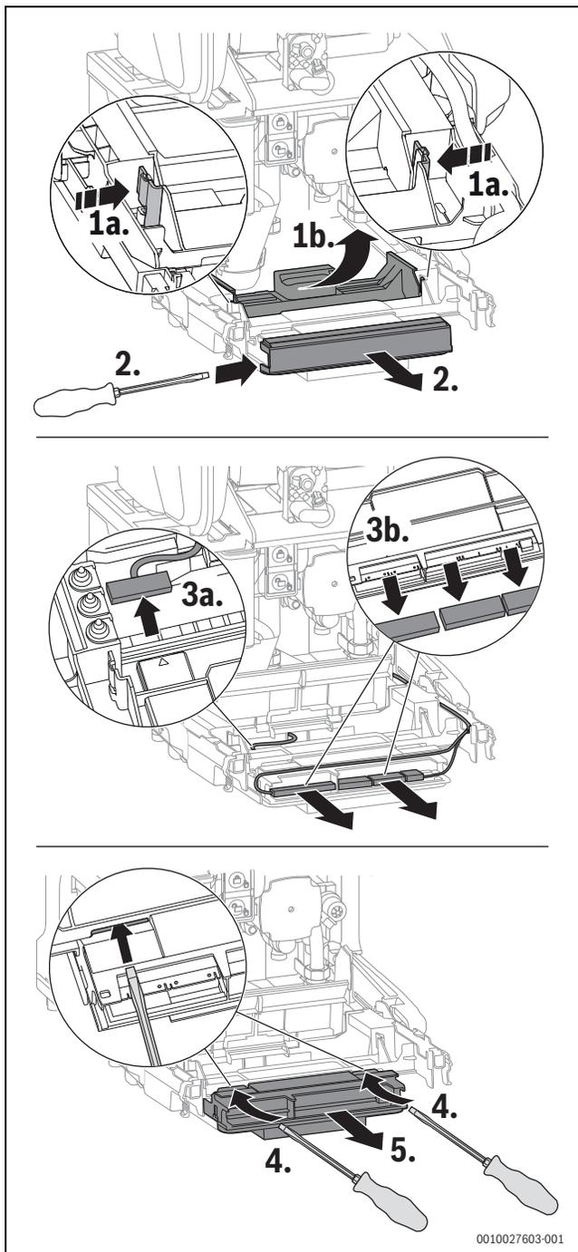
**Bild 82 Steuergerät herausnehmen**
