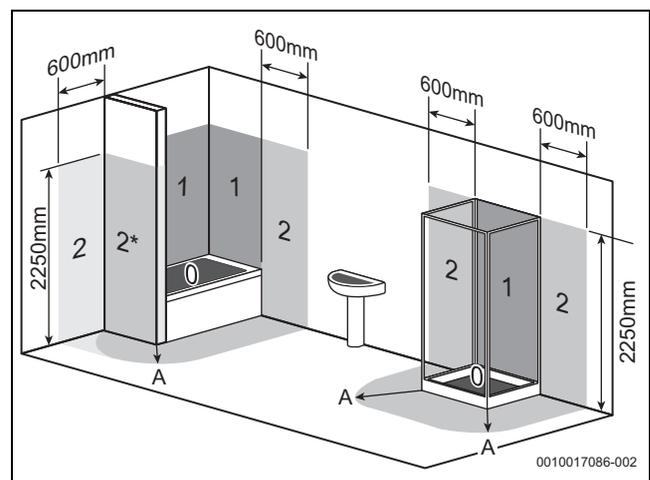
Bild 27 Schutzbereiche (Beispieldarstellung)
