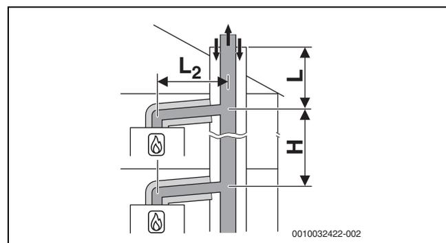
Bild 23 Mehrfachbelegung nach C<sub>(14)3x</sub> mit kollektiver starrer Abgasführung und konzentrischer Luft-Abgas-Führung im Aufstellraum
