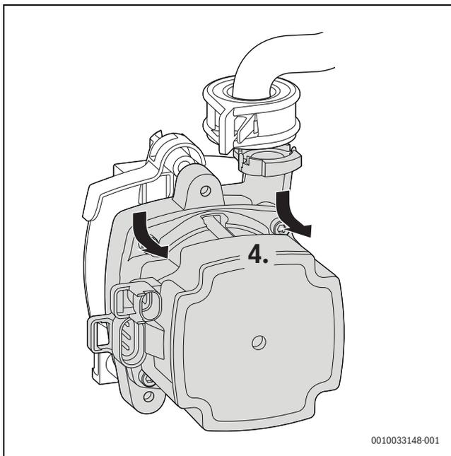
Bild 72 Heizungspumpe abnehmen
