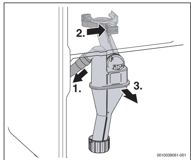
**Bild 83 Kondensatsiphon ausbauen**
