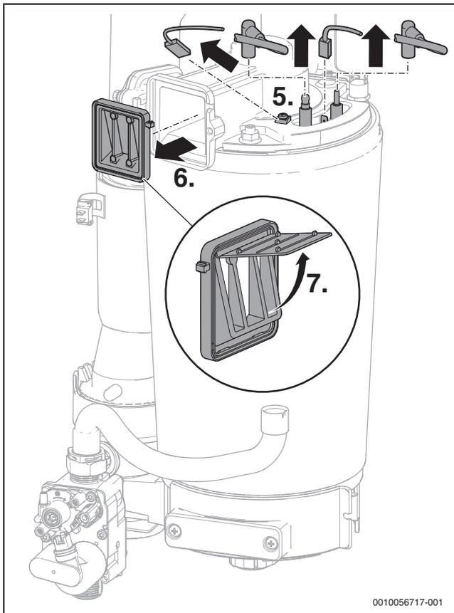
Bild 57 Kabel abziehen
