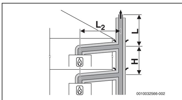
Bild 22 Mehrfachbelegung nach C<sub>(13)3x</sub> mit konzentrischer Luft-Abgas-Führung an der Außenwand und im Aufstellraum
