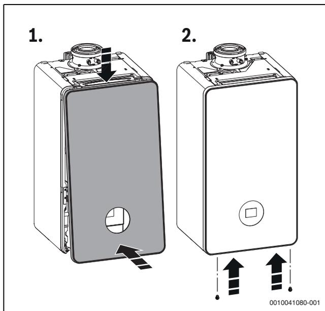
Bild 44 Verkleidung montieren
