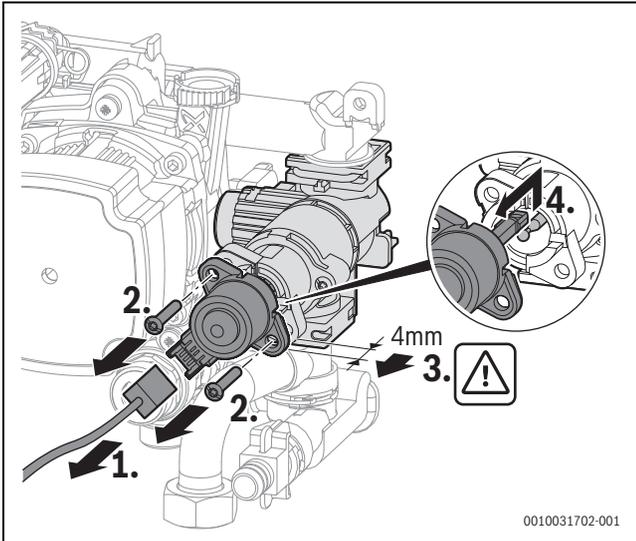
Bild 90 Motor am 3-Wege-Ventil ausbauen (Variante mit Schrauben)
