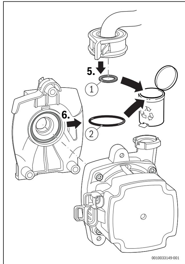
Bild 73 Dichtungen entsorgen
