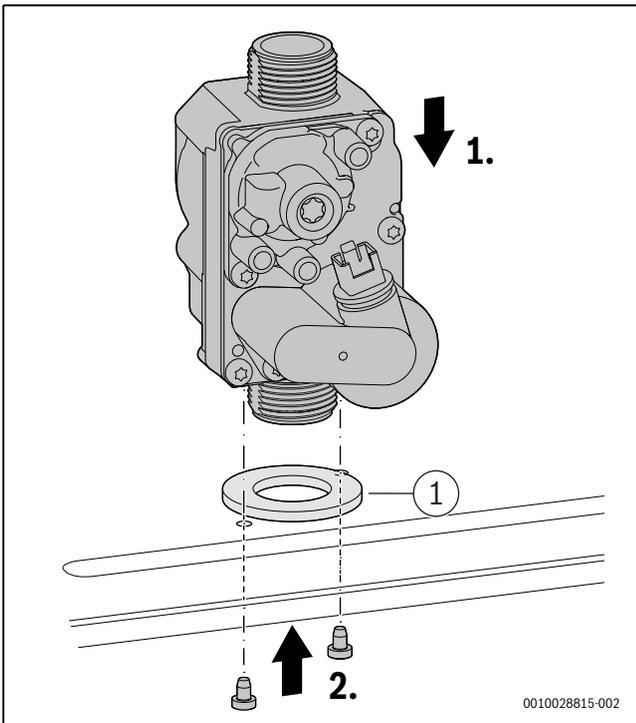
Bild 78 Gasarmatur einbauen
