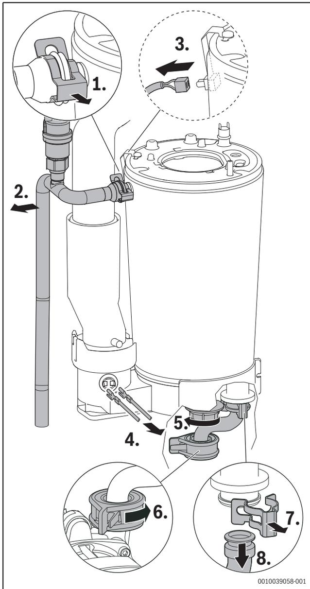
Bild 68 Vorlaufrohr lösen, Kabel abziehen und Rücklaufrohr lösen
