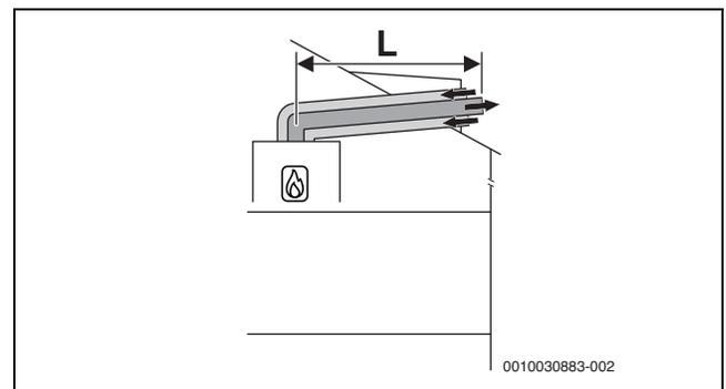
Bild 11 Horizontale konzentrische Luft-Abgas-Führung nach C<sub>13x</sub> über das Dach
