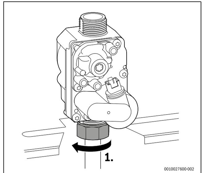
**Bild 76** Überwurfmutter lösen
