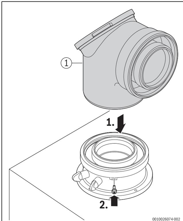
Bild 38 Abgaszubehör einsetzen und mit Schraube sichern
