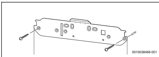
Bild 32 Aufhängeschiene montieren
