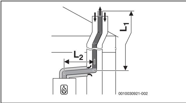
Bild 19 Flexible Abgasführung nach C<sub>93x</sub> im Schacht und konzentrische Luft-Abgas-Führung im Aufstellraum
