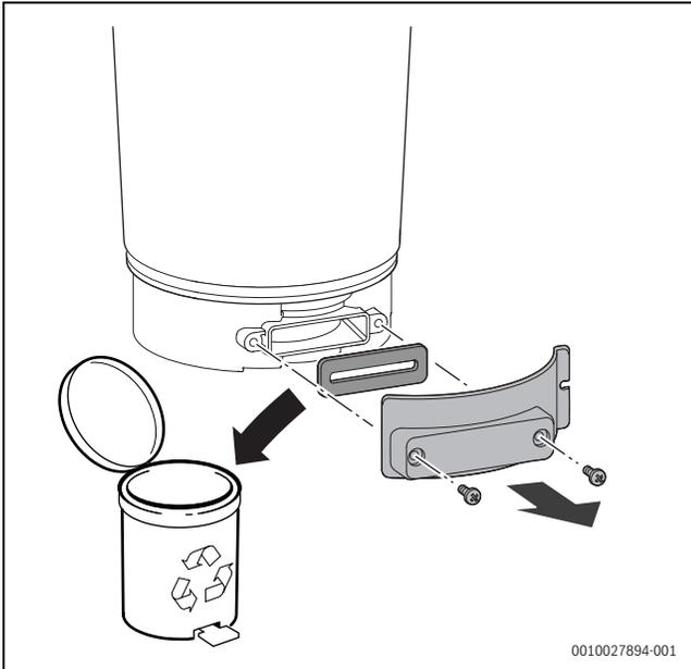
Bild 65 Prüfföffnung öffnen
