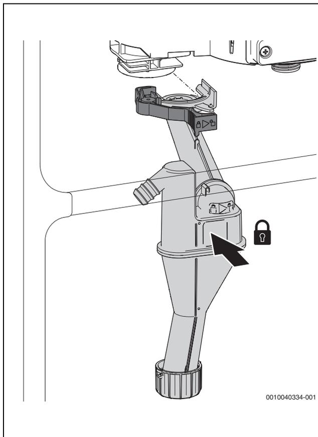
Bild 87 Kondensatsiphon einsetzen
