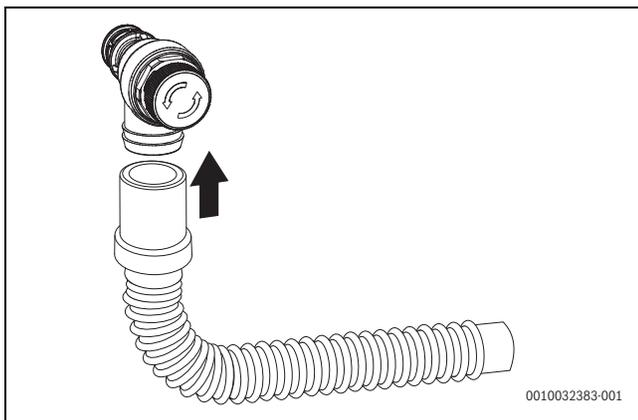
Bild 35 Schlauch am Sicherheitsventil (Heizung) montieren
