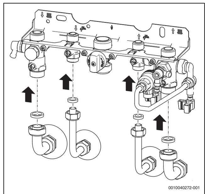
Bild 33 Rohre mit Dichtungen an Montageanschlussplatte (Zubehör) montieren
