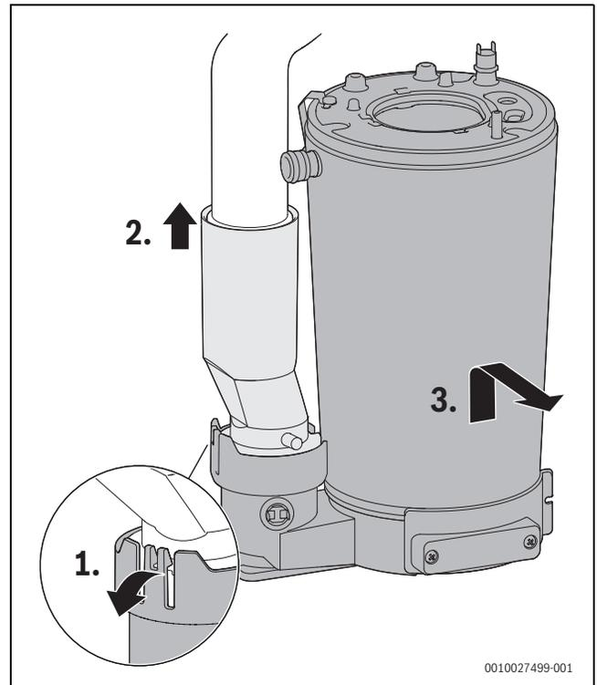
Bild 69 Wärmeblock ausbauen
