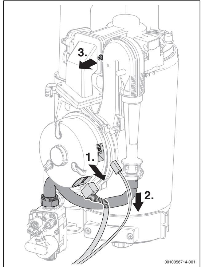
Bild 55 Stecker und Gasschlauch abziehen, Schraube lösen
