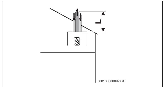
Bild 13 Vertikale konzentrische Luft-Abgas-Führung nach C<sub>33x</sub>
