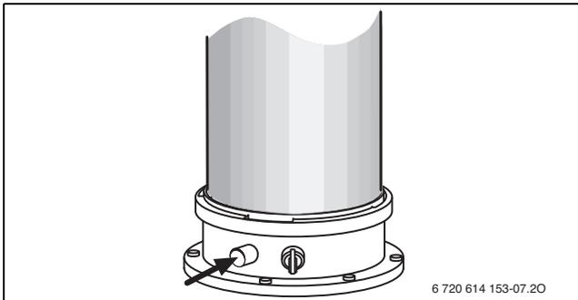
Bild 48 Abgasmessstutzen
