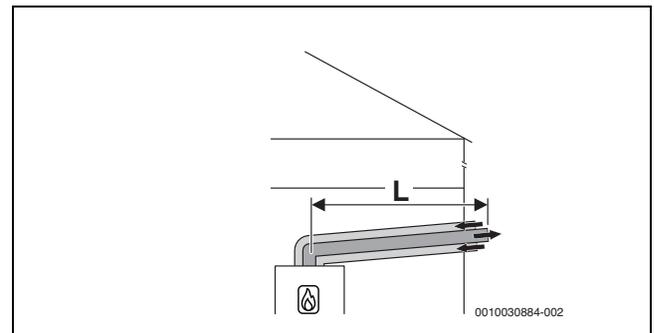
Bild 10 Horizontale konzentrische Luft-Abgas-Führung nach C<sub>13x</sub> durch die Außenwand
