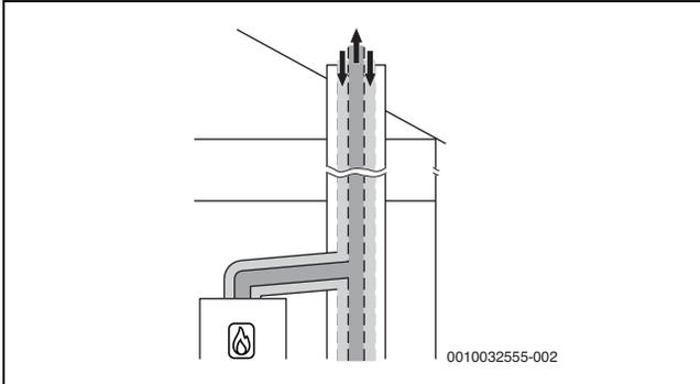
Bild 14 Konzentrische Luft-Abgas-Führung nach C<sub>43x</sub> im Aufstellraum
