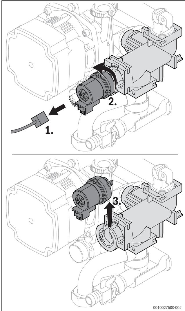
Bild 88 Motor am 3-Wege-Ventil ausbauen (Variante ohne Schrauben)
