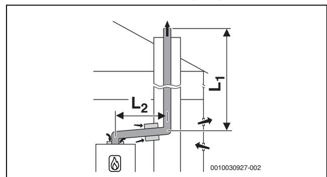
Bild 20 Starre Abgasführung im Schacht nach B<sub>53p</sub> mit raumluftabhängiger Luftzufuhr am Gerät und konzentrischem Verbindungsstück zwischen Aufstellraum und Schacht
