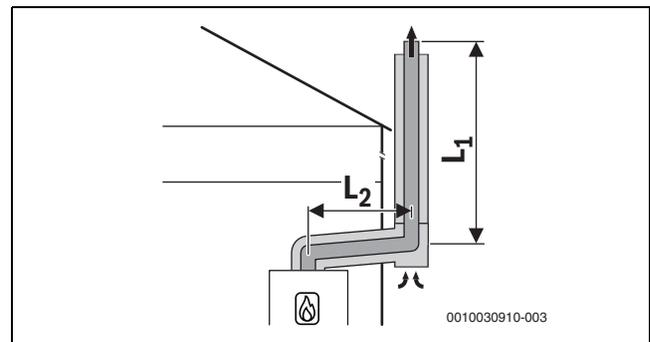
Bild 17 Konzentrische Luft-Abgas-Führung nach C<sub>53x</sub> an der Außenwand
