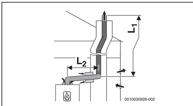
Bild 21 Flexible Abgasführung im Schacht nach B<sub>53p</sub> mit raumluftabhängiger Luftzufuhr am Gerät und konzentrischem Verbindungsstück zwischen Aufstellraum und Schacht
