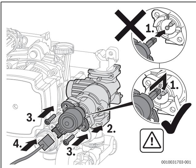
Bild 91 Motor am 3-Wege-Ventil einbauen (Variante mit Schrauben)
