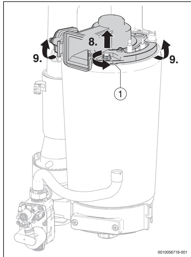
Bild 58 Brennerdeckel mit Gebläse und Mischeinrichtung abnehmen
