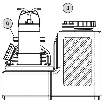
Fig. 6: Anschluss Be- und Entlüftung Sammelbehälter
