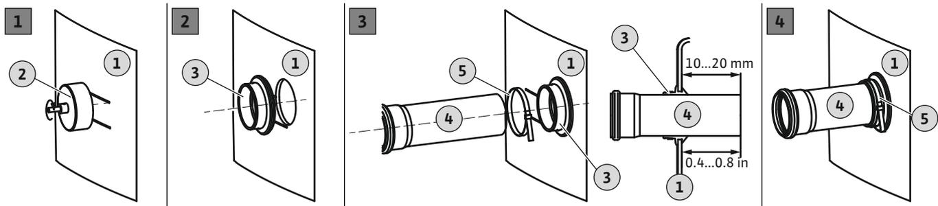
Fig. 5: Zulauf anschließen
