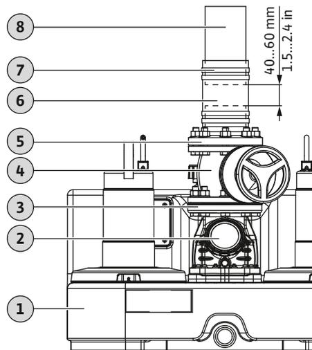
Fig. 3: Druckanschluss montieren
