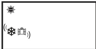
Die Wiederherstellung des Normalbetriebs erfolgt nicht automatisch, sondern muss durch Drücken der Taste „M“ aktiviert werden.
