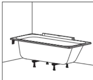
Die Wanne nach Montage der Wannenanker auflegen und über die Höhenverstellung der Wannenfüße ausrichten.
