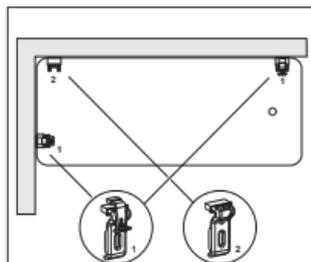
Die Wannenanker **mit** Klemmbügel (1) werden an den **Außenenden** der Bade- oder Duschwanne montiert.
