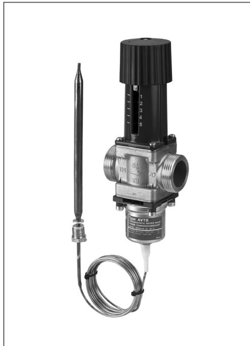
Der AVTB ist ein selbsttätiger Temperaturregler, der zum Regeln der Wassertemperatur in u. a. Warmwasserspeichern, Wärmeübertragern und Ölvorwärmern eingesetzt wird. Der Regler schließt bei steigender Temperatur.
