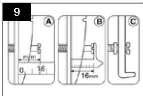
Mit Hilfe der beiliegenden Einstelllehre die Drückerstange(n) auf 16 mm einjustieren.
