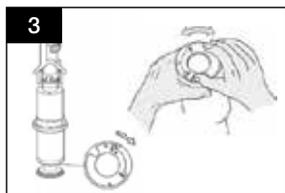
Die Wassermenge im UP-Spülkasten beträgt immer 9 l (werkseitig am Füllventil eingestellt). Die Spülmenge ist werkseitig auf 6/3 l eingestellt.
