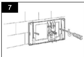
Montagerahmen mit den Befestigungsschrauben 4,2 x 45 mm an den Distanzbolzen befestigen.
