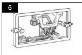
Panzerschlauch auf Eckventil stecken und fest verschrauben.
