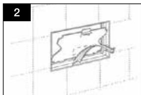
Entfernen Sie den Aussparungsklotz, sowie die Revisions-Schutzplatte, um die folgenden Einstellungen vornehmen zu können.
