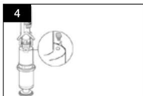
Die Einstellung der kleinen Spülmenge kann von 3 l auf 4,5 l geändert werden. Dazu den blauen Stopfen (liegt dem Spülkasten bei!) in das kleine Loch auf der Oberseite des Ablaufventils fest einstecken.
