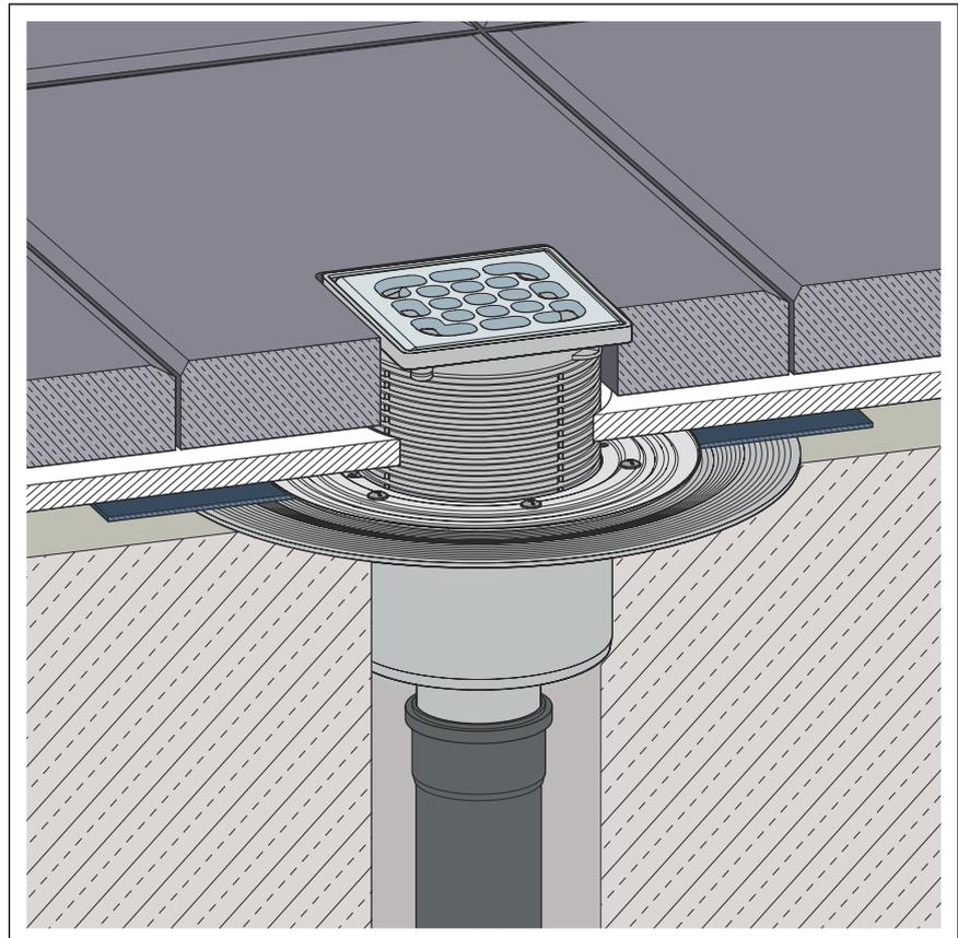
**Abb. 5: Schema einer konventionellen Abdichtung**
