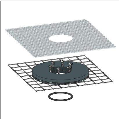
Für zusätzliche Stabilität kann der Advantix-Abdichtungsflansch (Modell 4924) aus Polymerbeton in den Bodenaufbau integriert werden.
