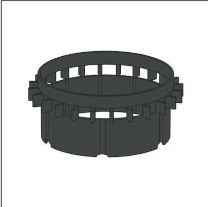
Der Ablauf kann mit dem Kiesfang-Einlaufelement (Modell 4946.3) ausgestattet werden, um Wasser neben dem Rost auch durch die Kies-schicht abzuleiten.
