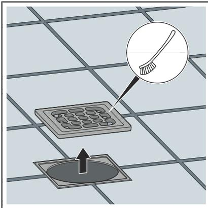
► Den Rost oder den Kiesfang entnehmen und reinigen.
