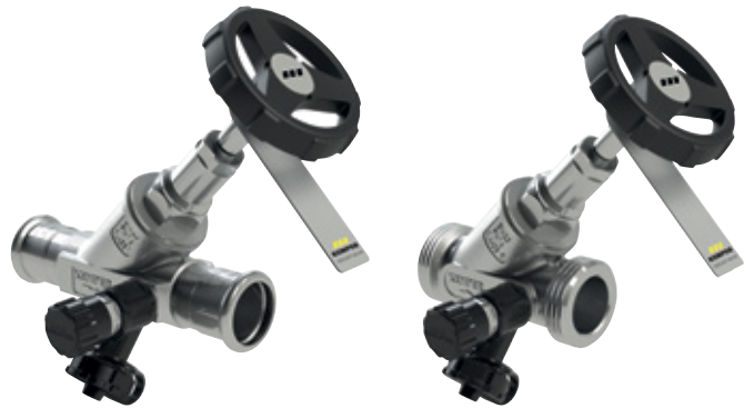
NIRO Freistrom-Absperrventil, mit Entleerung, mit fest integriertem Pressanschluss auf MAPRESS, Figur 073 01
