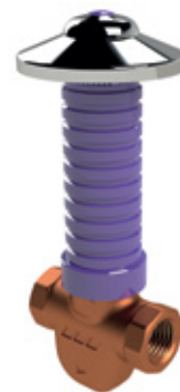
UP-ETA-THERM Unterputz automatisches Zirkulations-Regulierventil, 56 °C bis 58 °C, IG, Figur 540 02
