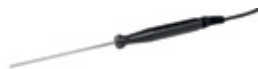
Hand-Temperaturfühler, Figur 138 00 003 Zum Messen von Wassertemperaturen, insbeson- dere von Trinkwassertemperaturen im Bereich des Auslaufes der Entnahmestelle vor Ort. Schnell reagierender Fühler zur Feststellung von Temperat- urschwankungen; Temperaturmessbereich 0 - 150 °C; 150 mm lange Messspitze aus Edelstahl; Kabellän- ge 1,0 m.
