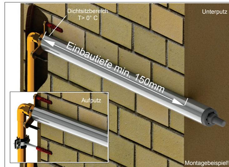
! Mögliche Wandstärken bei Aufputz-Montage: min. 150mm max. 420mm
