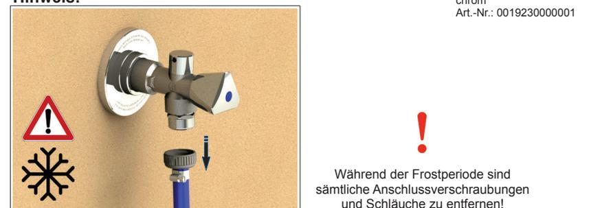
**Achtung!** Bevor Sie mit der Fertigmontage beginnen, ist das Rohrsystem druckfrei zu machen. Nach Montage der Armatur ist eine Druck- und Funktionsprüfung durchzuführen!
