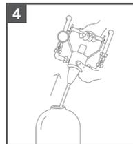
4. Ziehen Sie den 3-Wege-Kopf mit der Sauglanze aus dem Composite-Behälter.
