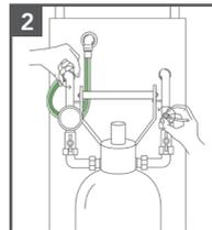
2. Entfernen Sie die Schläuche vom Gerät und öffnen Sie alle Ventile, um das Gerät zu entleeren.
