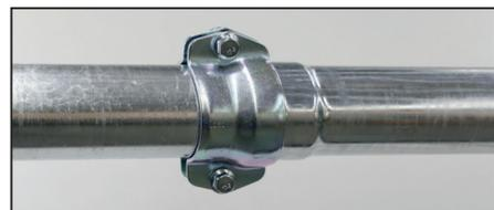
Füllleitungen und die erdverlegten Entlüftungsleitungen sind an den Verbindungsstellen der aufgeschobenen Muffe beidseitig mit Sicherungsschelle, Nr. 806X, gegen axialen Schub zu sichern.
