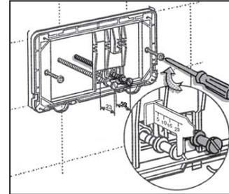
Montagerahmen mit den beiliegenden Schrauben an den Distanzbolzen befestigen.
