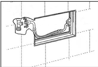
Panzerschlauch auf Eckventil stecken. Handfest verschrauben.
