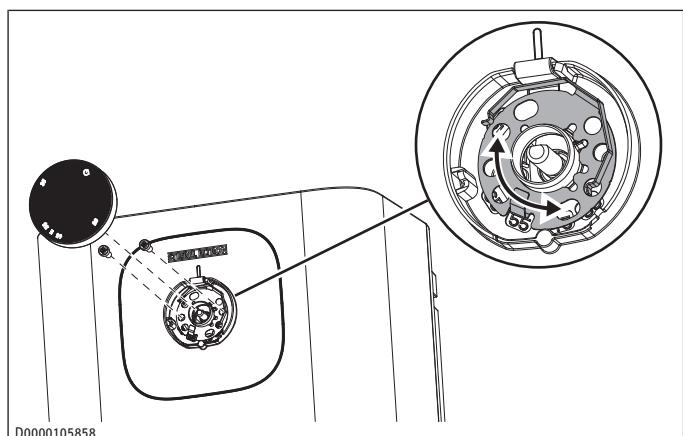
Omezovacím kroužkem pod knoflíkem regulátoru teploty můžete rozsah nastavení knoflíku regulátoru teploty omezit na maximální teplotu.
