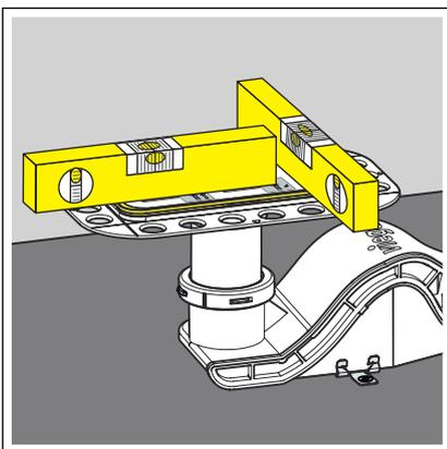
► Den Flansch in alle Richtungen waagrecht ausrichten und befestigen.
