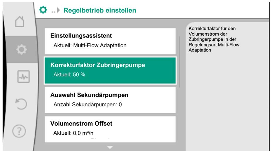
Fig. 37: Einstellung Korrekturfaktor Zubringerpumpe
