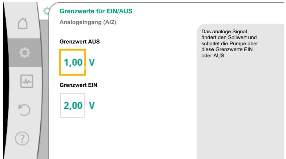
Fig. 59: Grenzwerte zur EIN/AUS-Steuerung über Analogsignale
