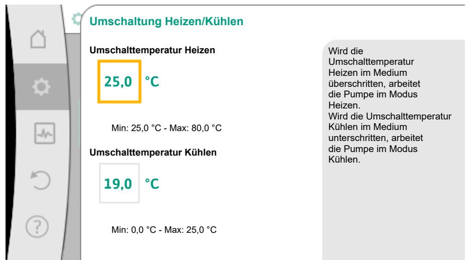
Fig. 28: Umschaltung Heizen/Kühlen\_„Umschalttemperaturen“
