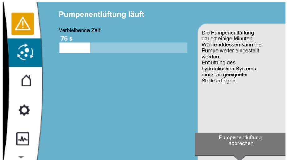
Fig. 9: Statusanzeige Entlüftung
