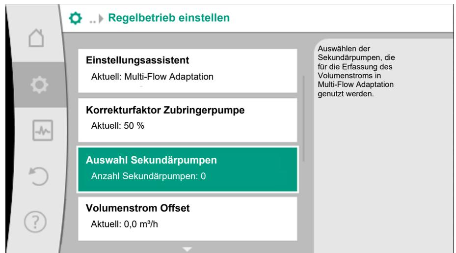
Fig. 36: Auswahl der Sekundärpumpen zu Multi-Flow Adaptation
