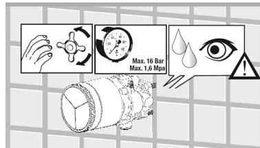
Nach erfolgter Endmontage (gemäß Anleitung LOGIC PLUS PUSH Thermostat) alle Verbindungen auf Dichtigkeit prüfen!
